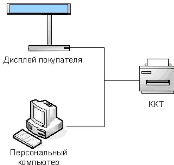
Рисунок 3. Подключение управляющих устройств к ККТ
