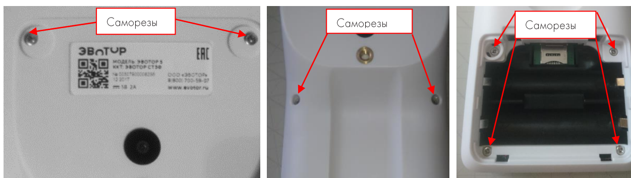
Рисунок 15. Саморезы, фиксирующие корпус СТ.
