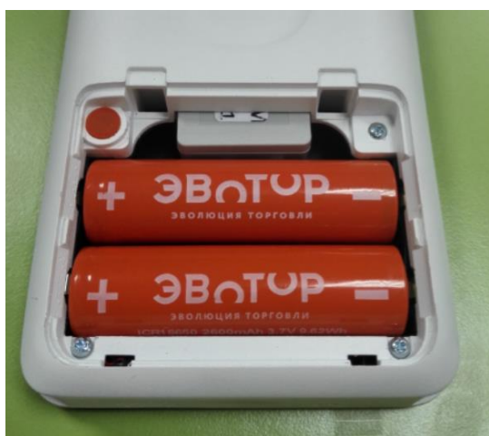
Рисунок 11. Извлечение аккумуляторов из отсека аккумуляторов СТ.
