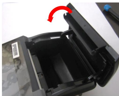
Рисунок 20. Демонтаж прижимного вала.
