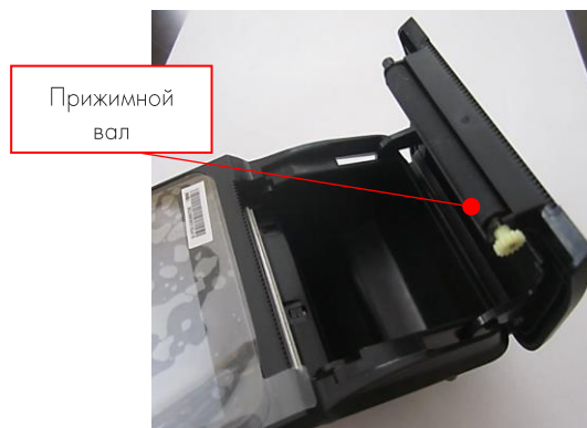
Рисунок 52. Установка прижимного вала.
