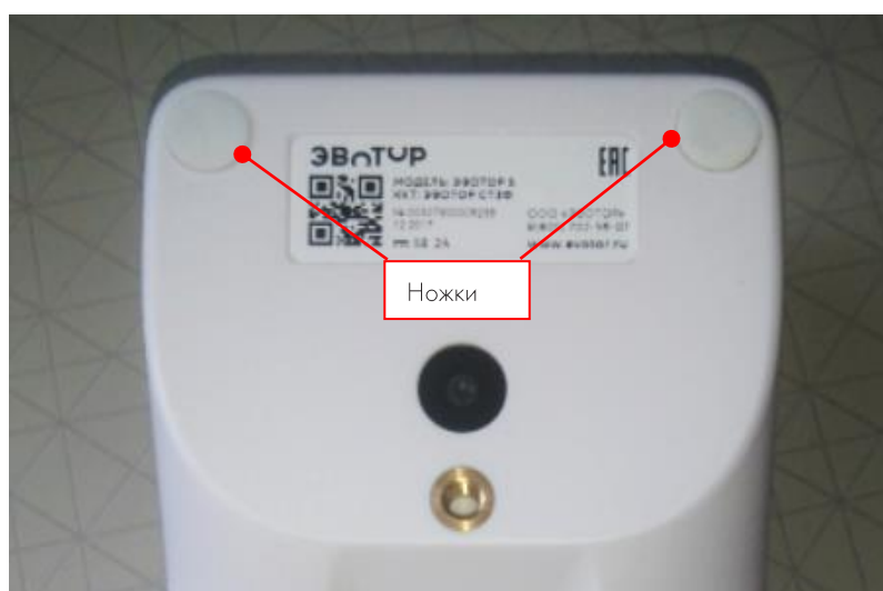
Рисунок 14. Демонтаж ножек в верхней части СТ.
