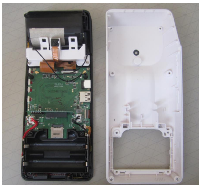
Рисунок 16. Демонтаж сборки с дисплеем.
