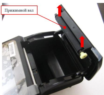
Рисунок 20. Демонтаж прижимного вала.
