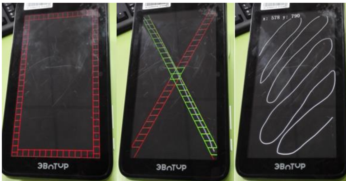
Рисунок 76. Тесты на работоспособность сенсорного экрана.
