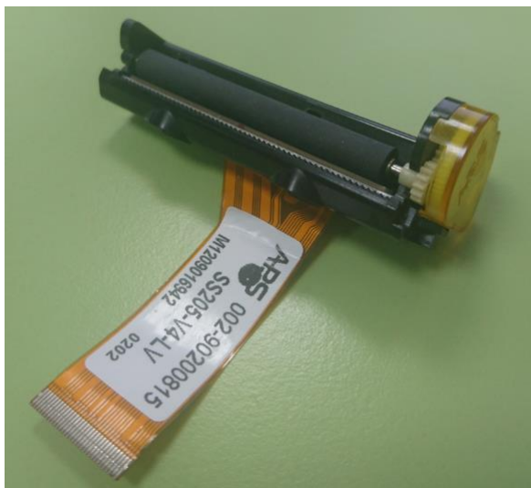
Рисунок 7. Термопечатающий механизм APS SS205-V4-LV.
