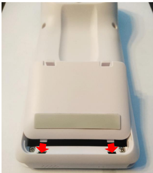
Рисунок 60. Крышка батарейного отсека.
