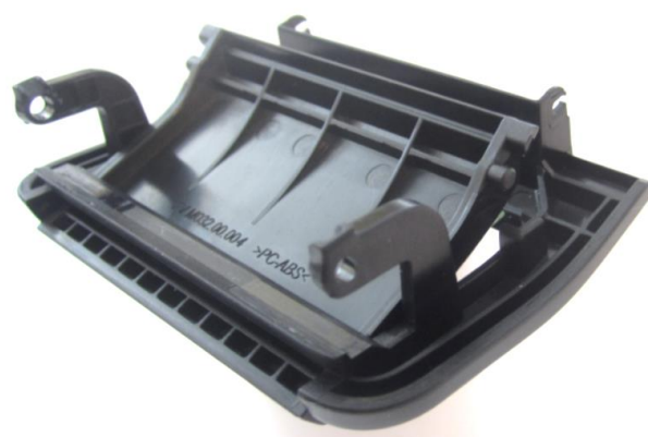
Рисунок 29. Демонтаж рычага крышки.
