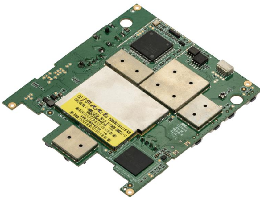
Рисунок 73. Модуль управления. Вид снизу
