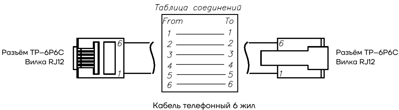
Рисунок 51. Схема кабеля денежного ящика
