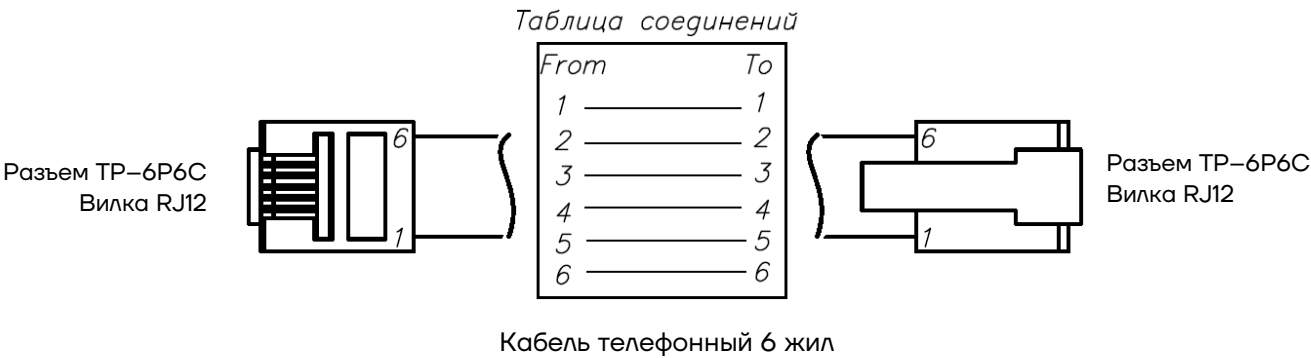
Рисунок 38. Схема кабеля денежного ящика
