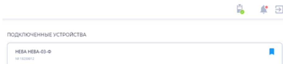
Убедитесь, что подключение ККТ прошло успешно и она функционирует штатным образом. Для осуществления проверки откройте смену, пробейте тестовые чеки приход и возврат прихода, закройте смену.
